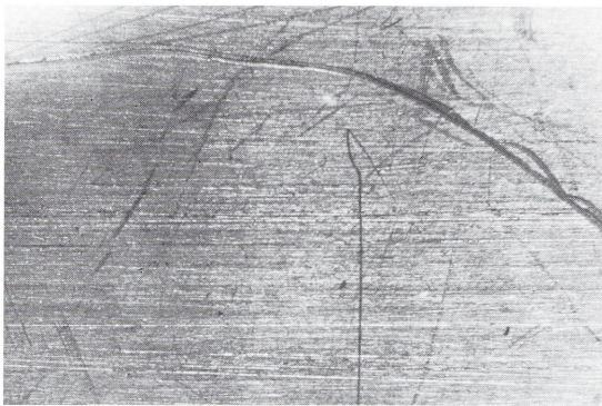
Abb. 18 Typische Oberflächenstruktur eines gewalzten Bleches
