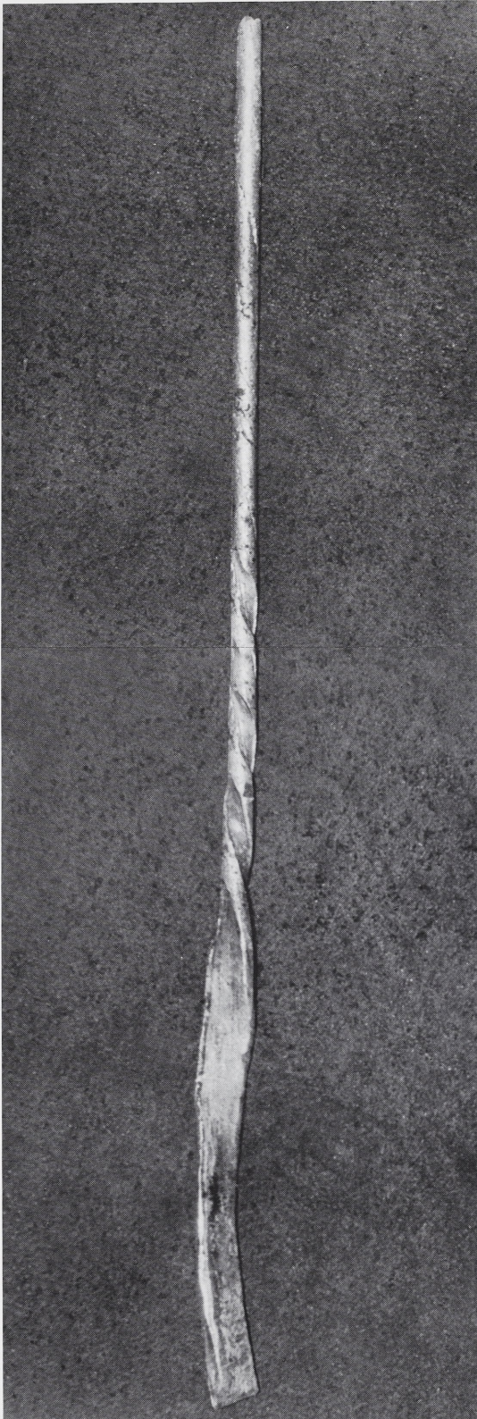
Abb. 13 Eigenes Experiment: Werdegang eines gerollten Drahtes
