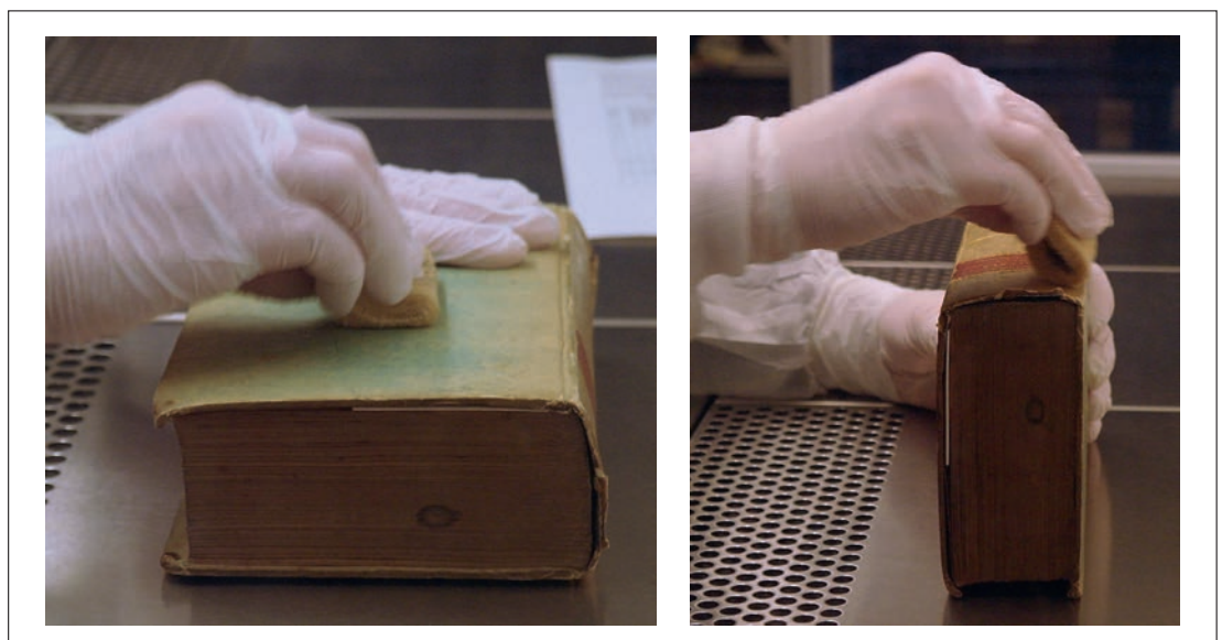
Abb. 3 und 4: Trockenreinigung von Büchern an der Sicherheitswerkbank mittels Latexschwamm. (Foto: Herzogin Anna Amalia Bibliothek, Weimar)
