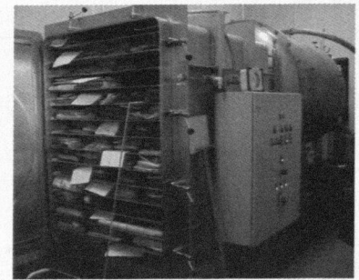
Abb. 2: Vakuumkammer mit Kondenser: geöffnete Vakuumkammer mit Trocknungsgut
