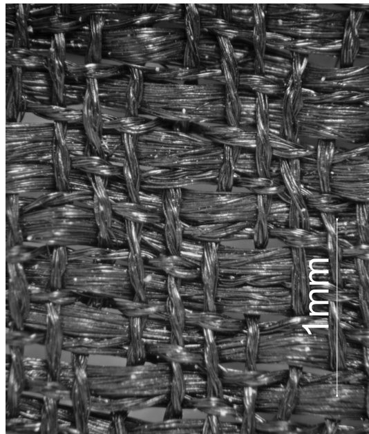
Abb. 4a und 4b: Aufnahmen mit Mikroskop Leica WILD M3C in Kombination mit einer Nikon-Kamera DXM 1200 in 16 und 40-facher Vergrößerung; es handelt sich um dasselbe Seidengewebe wie in Abb. 3. Abbildung: HTW Berlin, Studiengang Konservierung und Restaurierung/Grabungstechnik
