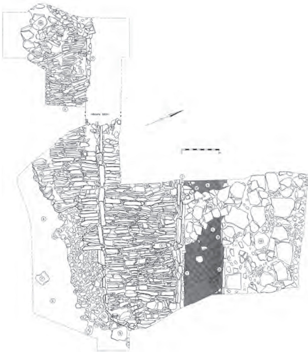
Pl. XXI. Trei modalități diferite de a pava o stradă, în trei faze succesive de construcție: cu prundiș și piatră de râu, cu lespezi de piatră și, în final, cu blocuri așezate pe cant (centru). Se observă că în cea mai evoluată fază strada are două benzi, separate printr-un șir de blocuri așezate în lung. Nienover (Bodenfelde, Saxonia Inferioară), secolul al XII-lea (STEPHAN 2011: 108).
