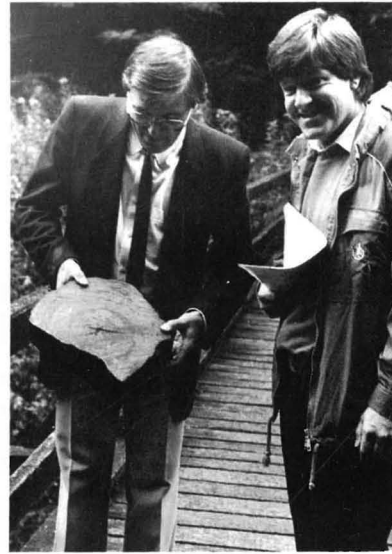
Abb. 5: Bergung zweier Scheiben der Brückenpfähle von Iffezheim für die dendrochronologische Untersuchung, Herbst 1984. Photos: J. Reinartz, Iffezheim.
