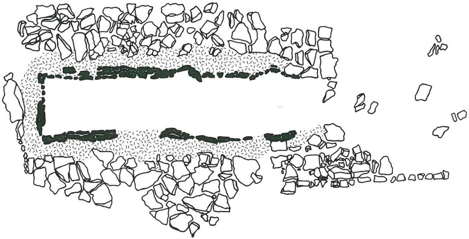
Abb. 16: Hüfingen, Schwarzwald-Baarkreis. Schmal-rechteckiger Brennofen für Ziegel oder Keramik. Der ungewöhnliche Grundriß läßt deutlich die stark verbrannte Innenwand der Brennkammer (schwarz), die Lehmhinterfütterung und die aus Bruchsteinen gesetzten Außenwände erkennen. Die Beheizung erfolgte von einer Schmalseite her. Das Brenngut wurde über dem Feuerraum auf eine gelochte Platte gestellt, von der sich allerdings bei diesem Ofen nichts erhalten hat. Maße des Feuerraums 3,00 x 0,60 m.
