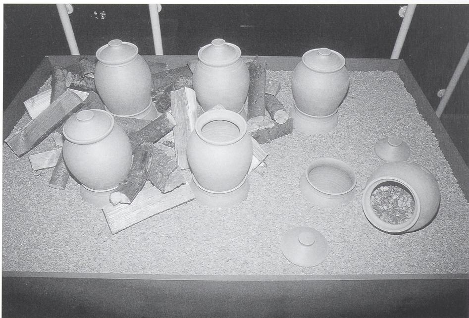
Abb. 6: Rekonstruktion einer einfachen Verhüttungsanlage für Antimonerze im Landesbergbaumuseum in Sulzburg.
