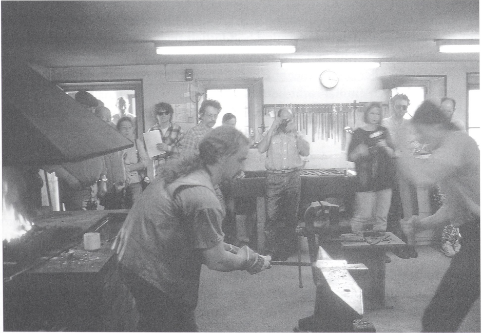
Abb. 2: Matthias Reinauer und Achim Weihrach schmiedeten den frisch erhitzten damazierten Klingenhohling aus.
