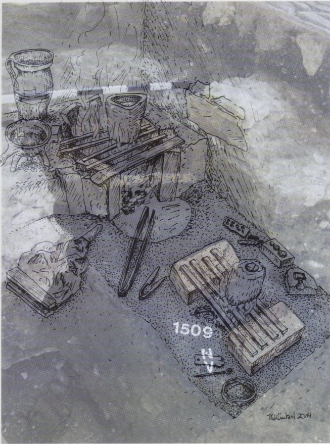
Abb. 5 Pforzheim, Rathaushof. Überlagerung von Befund und Rekonstruktion eines Schmelzofens für Buntmetall im Westflügel des Dominikanerklosters (14.-16. Jh.).
