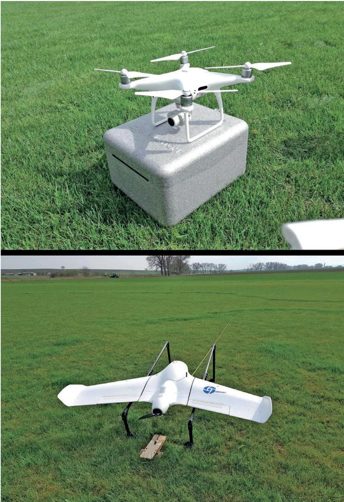
Abb. 3 Drohrentypen: Oben ein Multikopter, DJI Phantom 4 Professional, ein Quadrocopter. Unten ein Starrflügler, in diesem Fall ein Nurflügler, für Vermessungsflüge.
