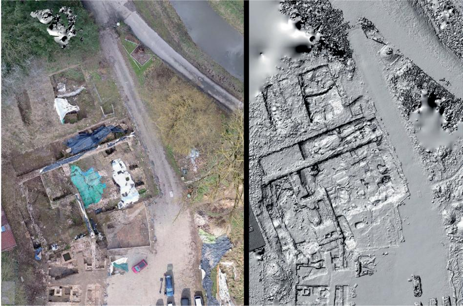
Abb. 8 Burg Wersau. Links das Orthofoto und rechts das Höhenmodell mit Schummern (Beleuchtung). Beide Datensätze sind maßhaltig und können direkt zu Umzeichnungen oder Analysen von Kanten, Tiefen und weiteren Informationen genutzt werden.
