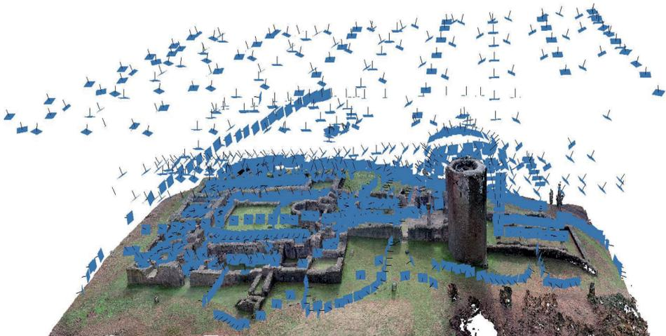
Abb. 10 Michaelskloster, Heiligenberg, Heidelberg. Dichte Punktwolke mit Kamerapositionen. Sehr gut sind die Drohnenaufnahmen und die bodengebundenen Aufnahmen zu unterscheiden.
