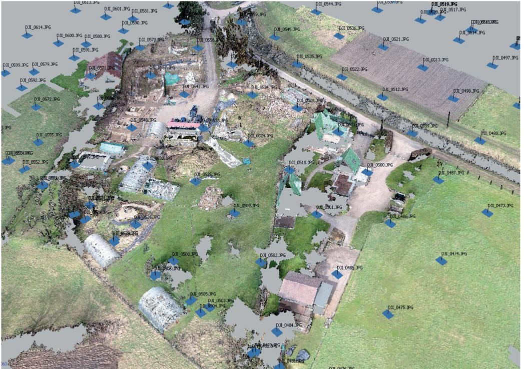
Abb. 6 Burg Wersau, resultierende Punktwolke in 3D-Ansicht mit eingeblendeten Kamerapositionen. Da der Flug ausschließlich zur Erzeugung eines Orthofotos diente, ist die Bodenaufösung mit 3cm/px nicht allzu hoch.
