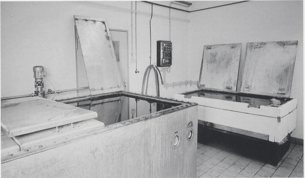
Abb. 5: Die zweite Naßholzkonservierungsanlage im MVF. Im Hintergrund die alte Gaudelsche Wanne, jetzt noch zusätzlich mit dicken Styroporplatten wärmeisoliert.
