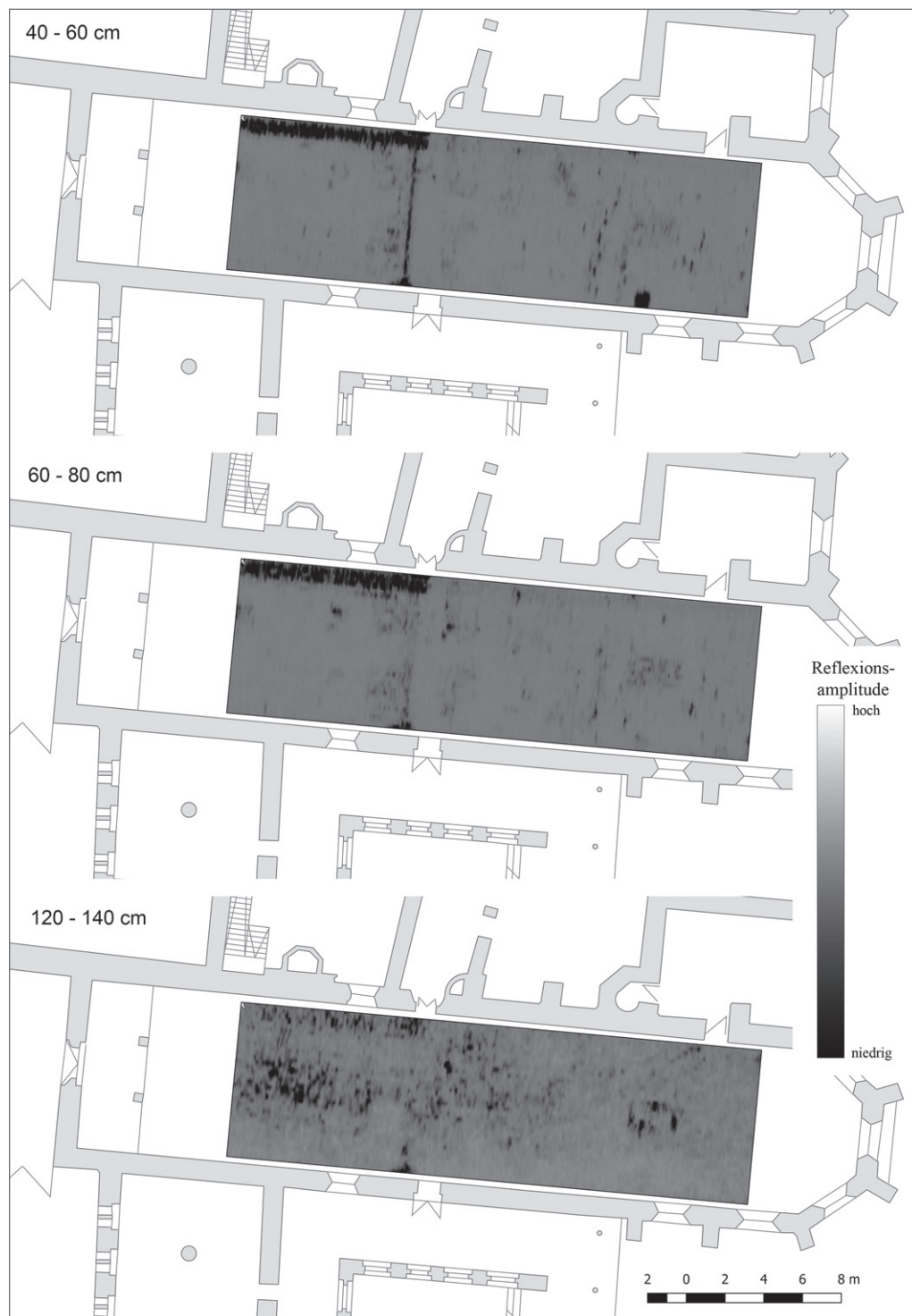
Abb. 12 Auswahl an Radartiefenscheiben im Bereich der Klosterkirche. Zwischen 40 und 60 cm Tiefe ist die nachkriegszeitliche Stiftergrablege erkennbar; zwischen 60 und 80 cm Tiefe das mutmaßliche Lettner sowie das Mauerfundament; zwischen 120 und 140 cm Tiefe das ursprüngliche Stiftergrab. GSSI SIR 4000 mit 900 MHz-Antenne, Messpunktabstand: 6 x 25 cm, Archivnr. 6532/021 Gnm21rad. Grafik: R. Linck (Planvorlage: Germanisches Nationalmuseum).
