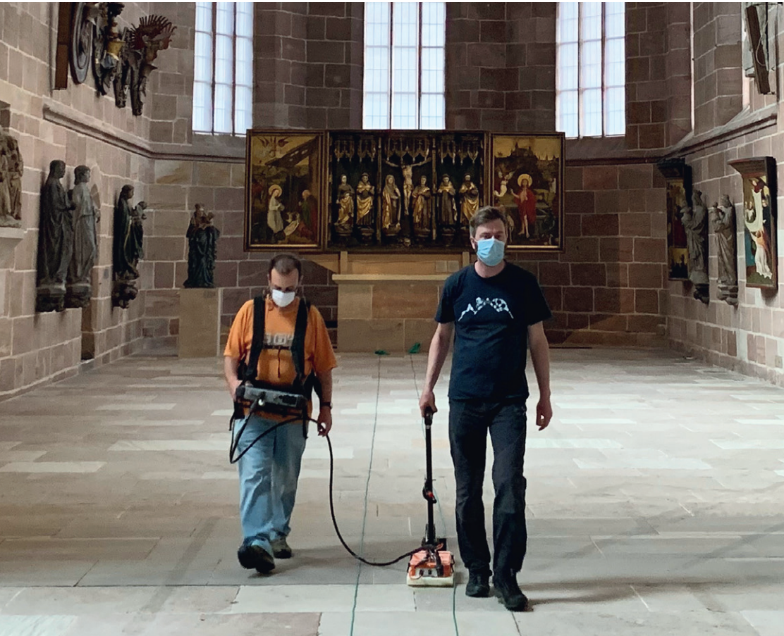
Abb. 2 Radargerät im Einsatz im Kirchenschiff des Kartäuserklosters. Die Messung wurde im Juni 2020 unter Einhaltung der geltenden pandemiebedingten Hygienevorschriften durchgeführt. Foto: A. Hofmann.
