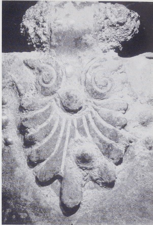
Abb. 20: Gegossene Palmettenschlaufe (Dendriten sichtbar!). Foto: H. Born.
