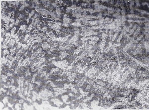
Abb. 12: Gußstruktur an einer Probe aus der Brustplatte (20-fach). Sammlung Axel Guttman 136. Foto: H. Born.
