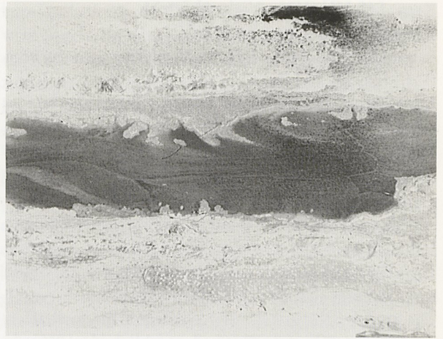
Abb. 6: Phosphorätzung des Querschnitts in sechsfacher Vergrößerung.
