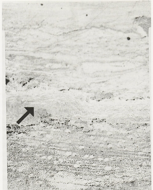
Abb. 7: Querschnitt in 40-facher Vergrößerung, ungeätzt. Die Fellauskleidung der Scheide ist hier sichtbar (Pfeil).
