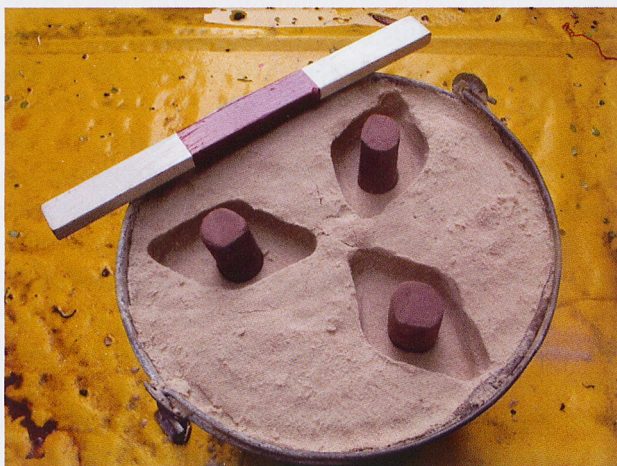
Abb. 8: Experimenteller Aufbau für den Guss von Schaftlochäxten in einer Sandform. Foto: J. Heeb.
