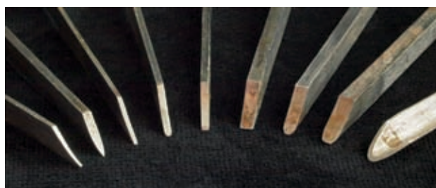
Abb. 8: Moderne Stahlstichel verschiedener Querschnittformen zum Gravieren mehr oder weniger filigraner Vertiefungen. Ein dem zweiten Stichel von links vergleichbares Werkzeug wurde zum Gravieren des Beiles benutzt. Foto: D. Berger.
