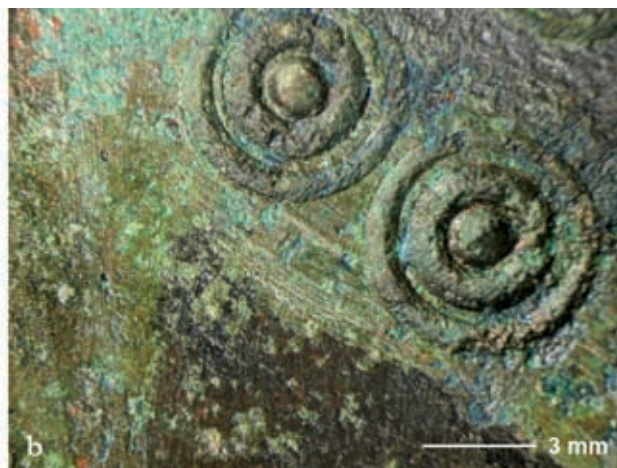
Abb. 21: a) Mikroskopische Detailaufnahme der grünen Streifen auf der Beilrückseite und der an den Stellen durch Abtrag der Korrosionsschicht verursachten Kratzspuren. b) Weitere Stelle mit Kratzern auf der Vorderseite des Beiles. Der Rauigkeitsunterschied zwischen den unterschiedlich korrodierten Bereichen ist hier auch sehr gut zu erkennen. Aufnahme: D. Berger.
