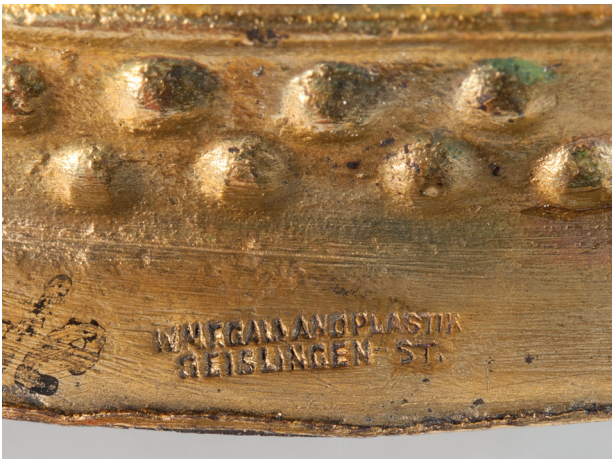
Abb. 7 Firmenstempel der galvanoplastischen Kunstanstalt der Württembergischen Metallwarenfabrik in Geislingen an der Steige (WMF) am Rand einer der ursprünglich aus dem Bestand des Leipziger Völkerkundemuseums stammenden, 1995 vom Museum für Vor- und Frühgeschichte aus dem Bestand des Museums für Deutsche Geschichte in Ost-Berlin übernommenen Schalenkopien. Foto: Museum für Vor- und Frühgeschichte, Staatliche Museen zu Berlin, C. Klein.
