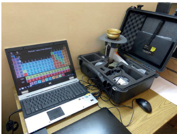
Abb. 14 Zerstörungsfreie Analyse einer der Goldschalen aus dem Hortfund von Eberswalde mit einem Röntgenfluoreszenzgerät im Staatlichen Museum für Bildende Künste A.S. Puschkin Moskau. Foto: E. Pernicka.
