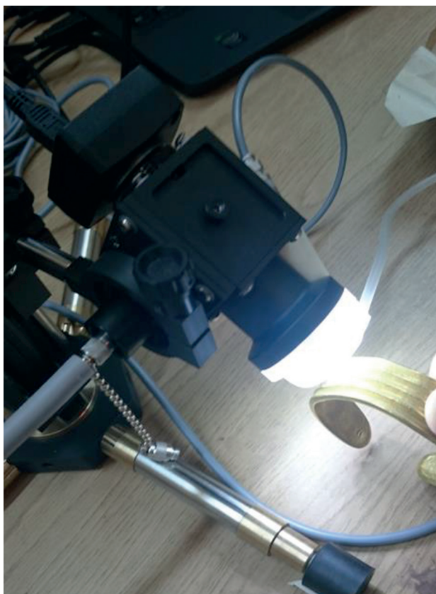
Abb. 22 Probennahme an einem Goldarmband aus dem Hortfund von Dieskau mit dem pLA-Gerät. Foto: P. Velicsanyi.
