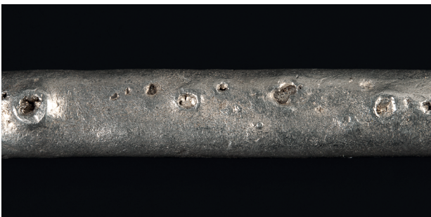
Abb. 35 Barren (Ia 4062l). Artefakte vom Guß in der offenen Form auf der Unterseite eines Barrens. Foto: C. Klein.
