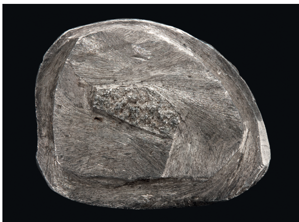
Abb. 39 Barrenfragment (Ia 4062q). Moderne Sägeschnitte bis zum Abbruch eines (heute verlorenen) Barren-Teilstücks mit der Aufsicht auf die Gussstruktur des Silbers im Zentrum. Foto: C. Klein.
