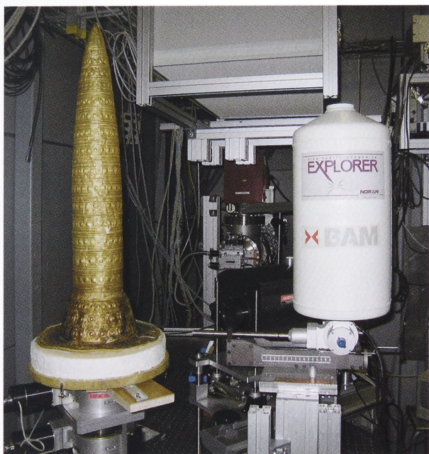
Abb. 5: Der Goldhut im RFA Messaufbau an der BAM-line in Berlin-Adlershof. Die Montage des Objektes auf einem motorisierten xyz-Tisch. Der Strahl fällt auf dem Bild von rechts kommend auf die Probe. Die Auswahl der Messpunkte erfolgte mit dem Mikroskop, die Detektion der charakteristischen Strahlung mit einem Reinstgermanium Halbleitdetektor. Foto H. Born.
