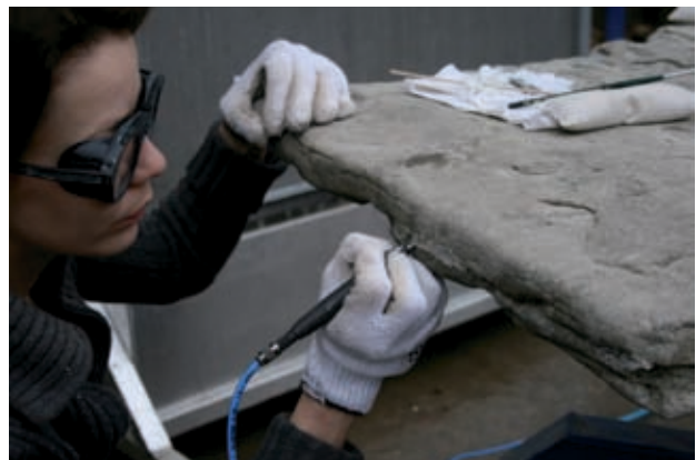
Abb. 4: Micromeißeltechnik in der OPUS Denkmalpflege GmbH Werkstatt. Foto: T. P. Otto.
