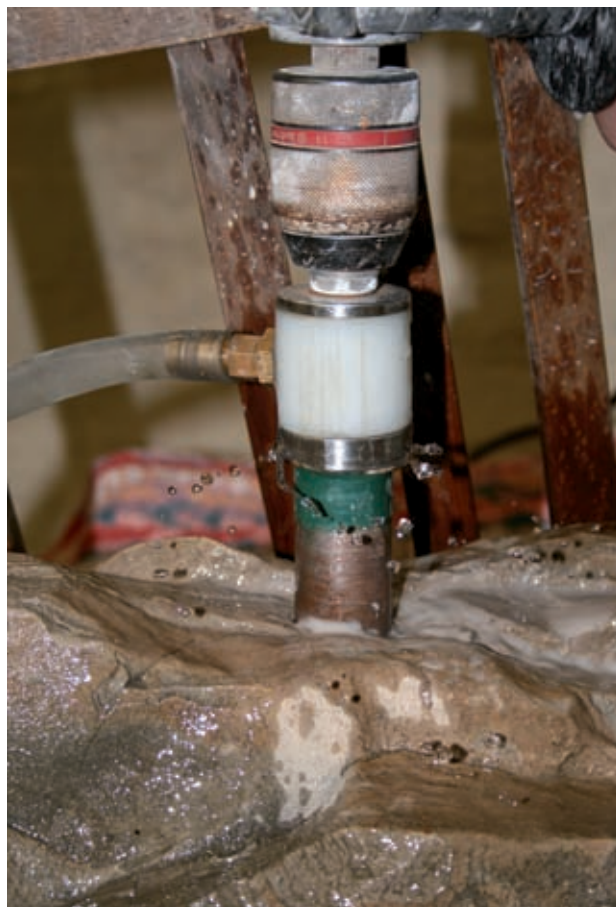
Abb. 6: Kernbohrung in der OPUS Denkmalpflege GmbH Werkstatt. Foto: T.P. Otto.
