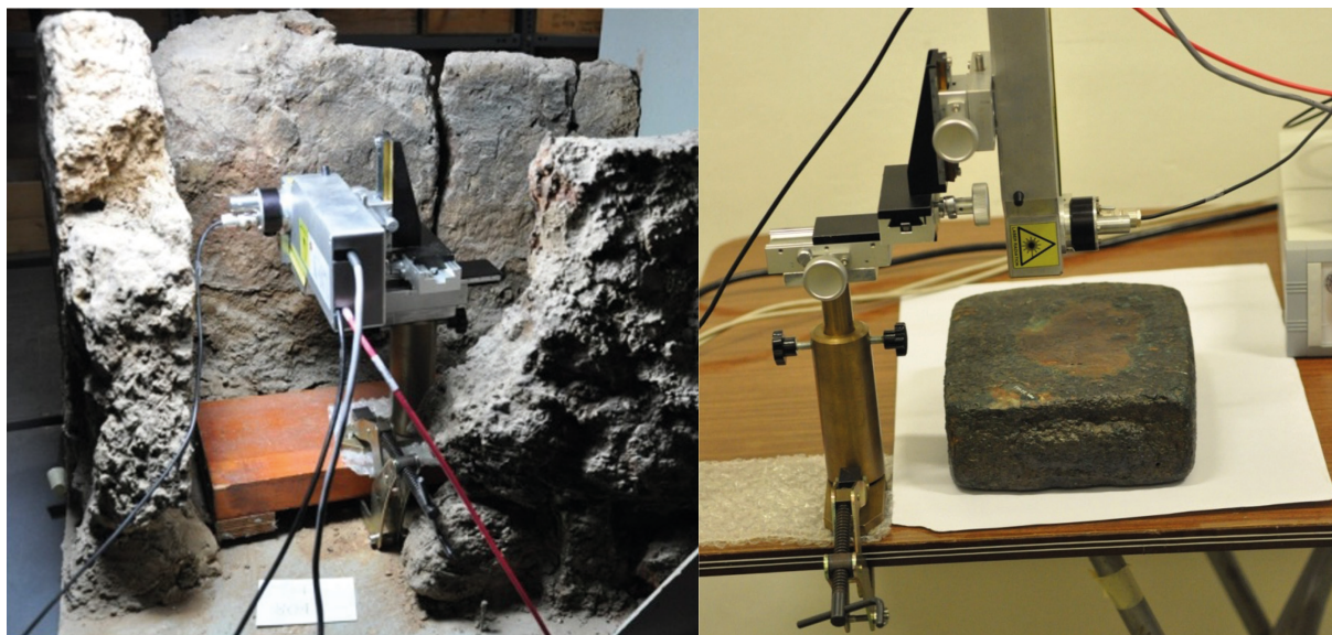
Abb. 3 Beispiele eines Messapparats in Nutzung. Links: In-situ Analyse eines bronzezeitlichen, metallurgischen Ofens. Rechts: Analyse eines Metallbarrens zur Herkunftsbestimmung (Quelle: Panagiotis Siozos, IESL-FORTH).
