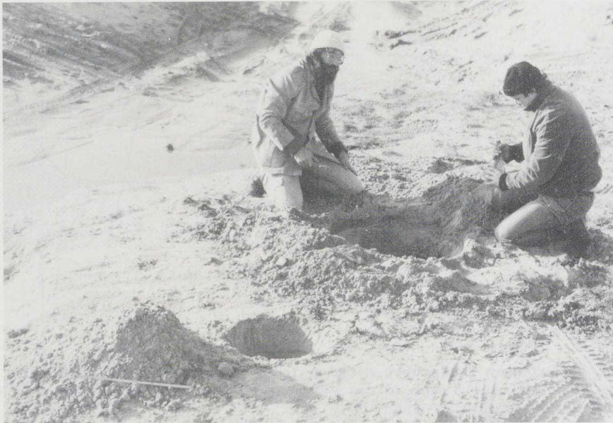
Abb. 2 Das Ausschachten der beiden Gruben im natürlich abgelagerten, feuchten Decksand. Die oberste, podsolierte Schicht wurde maschinell entfernt. Sandgrube Wildervank, November 1986.
