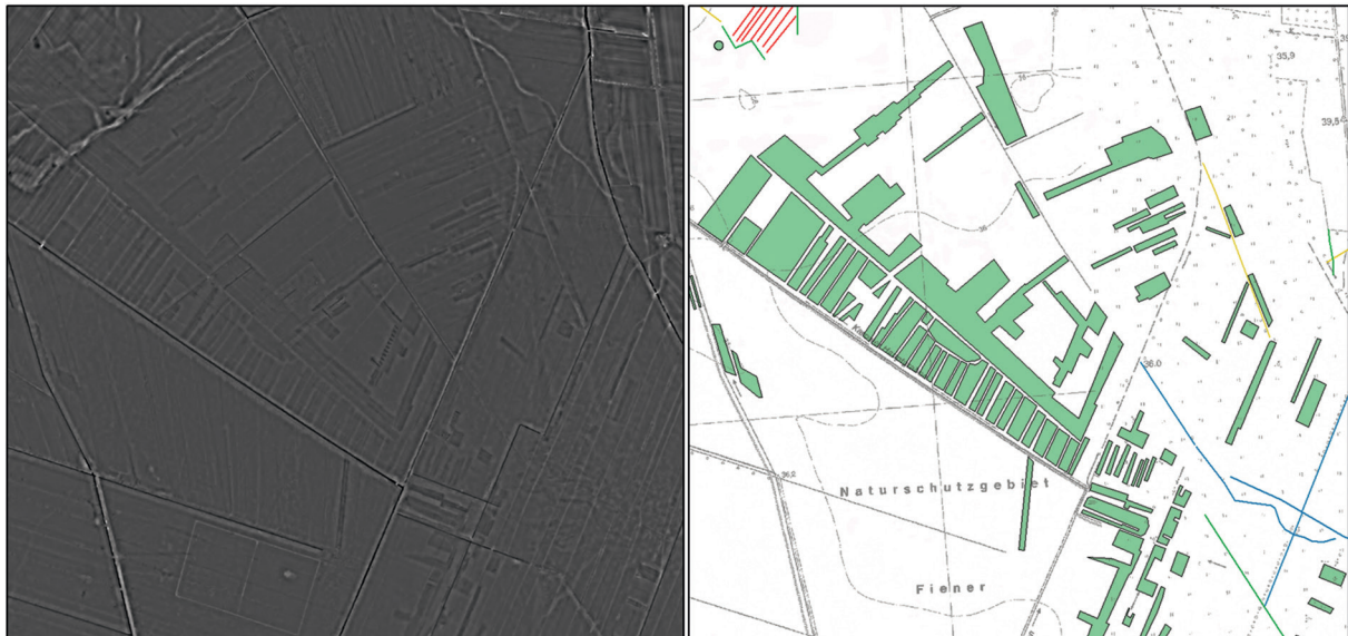
Abb. 15 Digitale Erfassung von Torfstichen, die größte Landschaftsveränderung des 19. Jh., bei Karow auf Grundlage von LiDAR-Scans (Kartierung nach M. Freudenreich auf Basis des digitalen Geländemodells, DGM 1; Kartengrundlage linke Abbildung: Laplacian-of-Gaussian-Visualisierung, abgeleitet vom DGM 1, © GeoBasis-DE/LVermGeo LSA, 2020; Kartengrundlage rechte Abbildung: Topografische Karte 1:10.000, © GeoBasis-DE/LVermGeo LSA).
