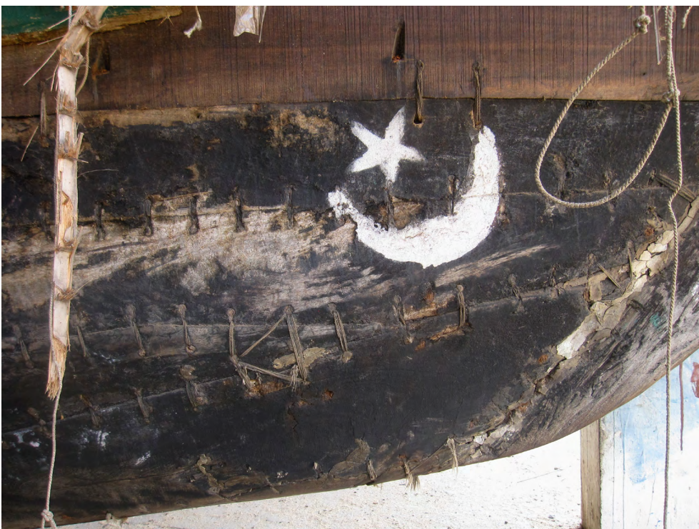
Fig. 8 »Kraweelbauweise« eines Plankenbootes mit Symbol von Sichelmond und Stern, Madhipuram, Foto: Jürgen Wasim Frembgen.
