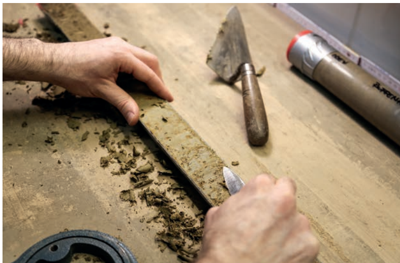
Abb. 6. Nachbearbeitung der Bohrkern im Labor. Zu Dokumentationszwecken werden die halbierten Bohrprofile geputzt, fotografiert und beschrieben, bevor Proben zur chemischen Analyse genommen werden (Foto: I. A. Hohle).
