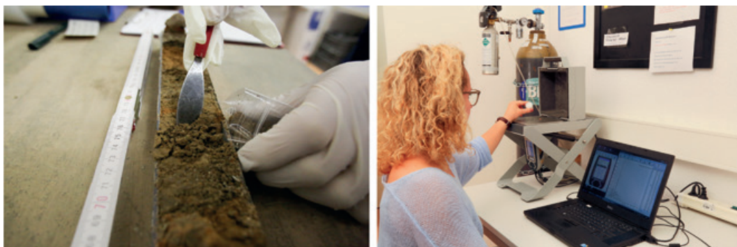
Abb. 37. Messung von Bodenproben durch M. Podgorelec mit dem Niton™ XL3 t RFA-Analysator (Fotos: J. Kalmbach, RGK).
