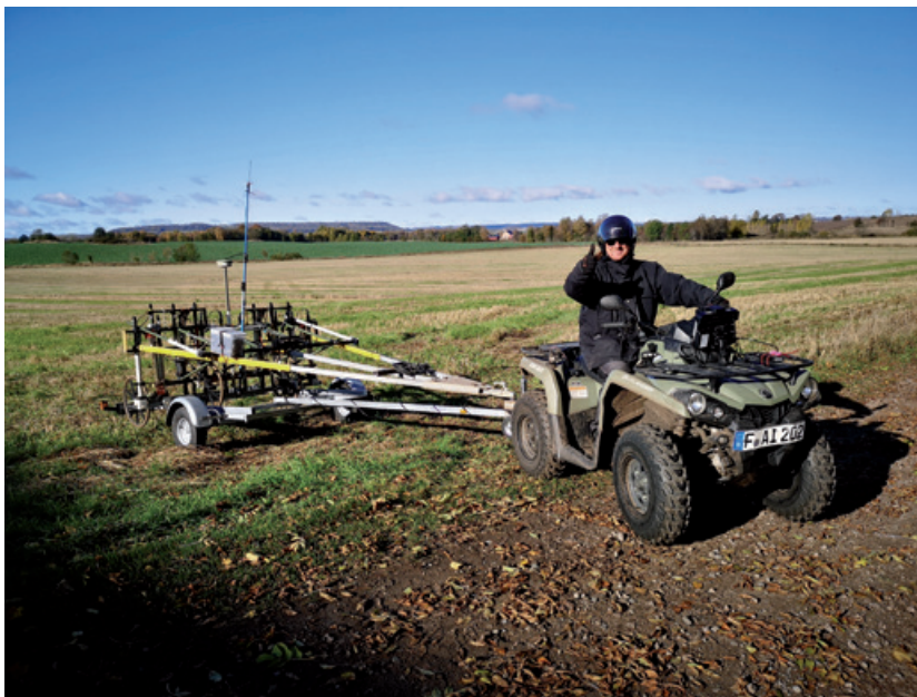
Abb. 34. Umgebauter Anhänger für den Transport des Geomagnetikmessgerätes über kurze und mittlere Distanzen (Foto: K. Rassmann, RGK).
