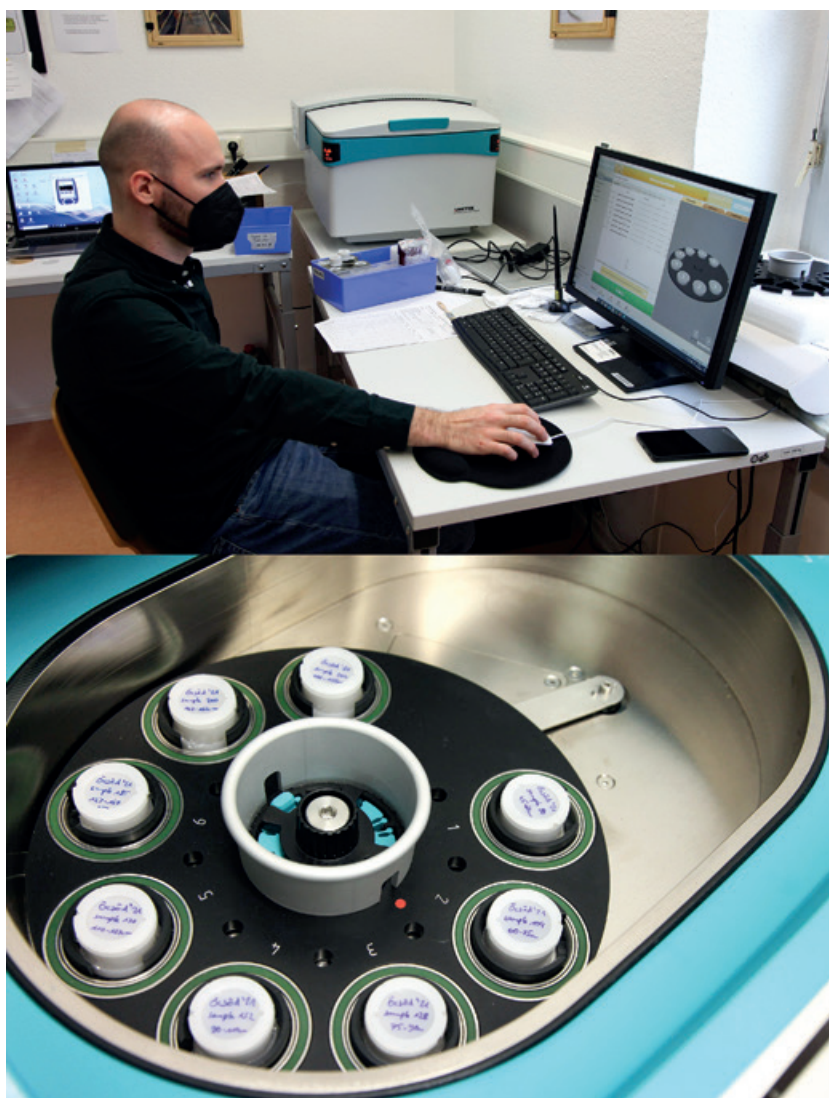
Abb. 54. Die neue benchtop ed-RFA (Spectro Xepos) im Einsatz. Durch 8er- und 12er Probenteller wird das Messen von Bodenproben in sample cups oder als Presslinge vereinfacht und automatisiert (Fotos: I. A. Hohle, RGK).
