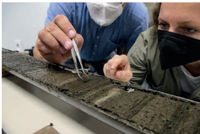
Abb. 47. Nach einer ersten stratigraphischen Ansprache der Bohrkerne werden Makroresten für ^{14}\text{C} -Analysen zur Datierung der Schichten entnommen (Foto: K. P. Hofmann, RGK).
