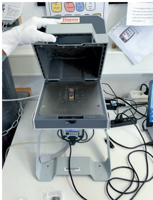
Abb. 30. RFA-Analyse keltischer Münzen. Links: Regenbogenschüsselchen aus dem Landesmuseum Darmstadt. Rechts: Positionierung eines Regenbogenschüsselchens in der Probenkammer der Niton XL3 t/RFA (Fotos: Axel Posluschny, Forschungszentrum Glauberg / hessenArchäologie).
