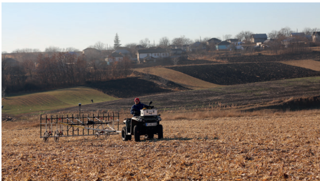
Abb. 16. Magnetische Messungen auf der Siedlung von Mihaileni bei Drochia mit dem MX-16 Sondensystem der Fa. Sensys (Foto: K. Rassmann, RGK).
