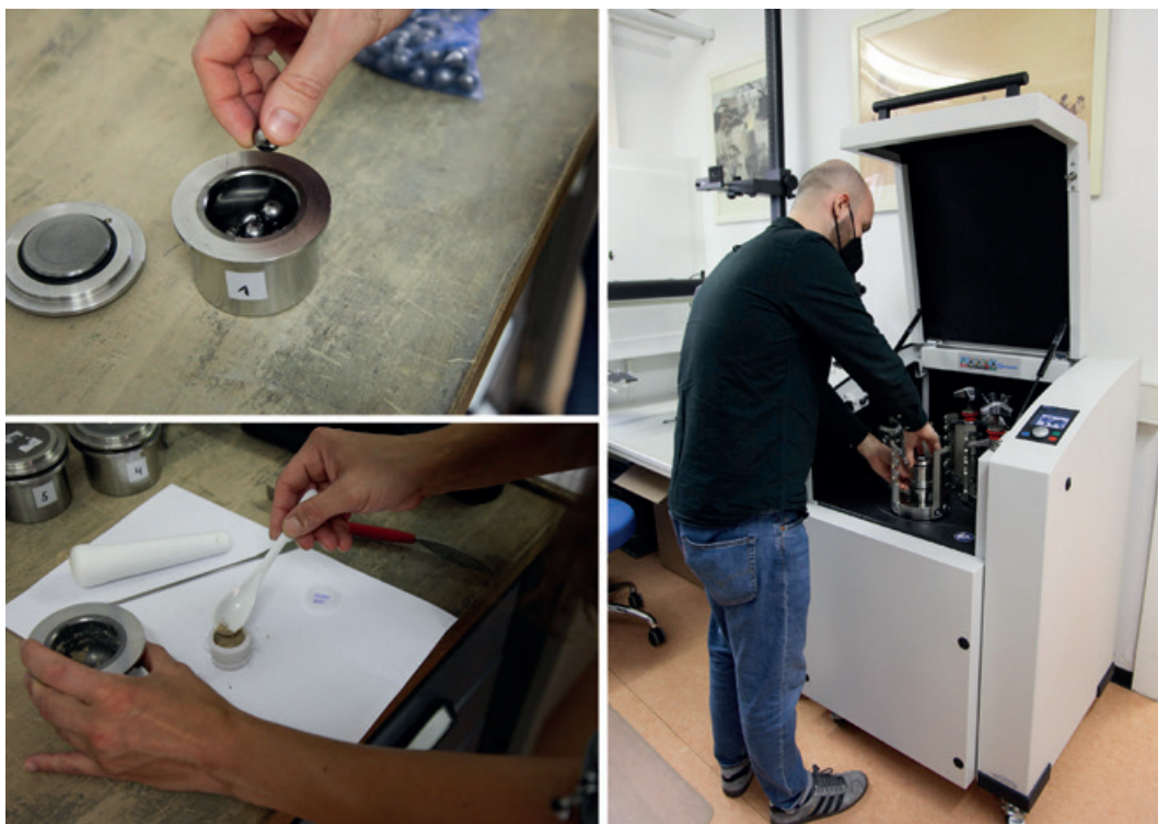
Abb. 53. Die Planetenkugelmühle zum Mahlen und Homogenisieren von Bodenproben im Einsatz. Es können bis zu acht Proben gleichzeitig gemahlen werden (Fotos: I. A. Hohle, RGK).
