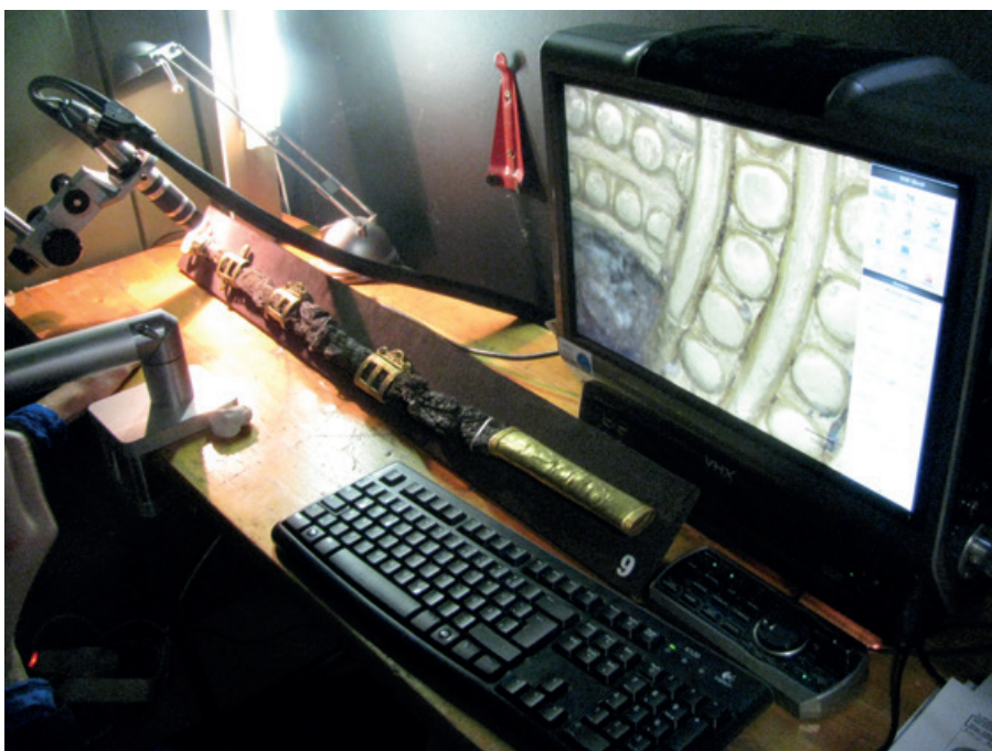
Abb. 5. Einsatz des Gelenkarmes bei der Untersuchung des Ringknaufschwertes aus dem Grab 1 von Kunbábony (Foto: H.-U. Voß, RGK).
