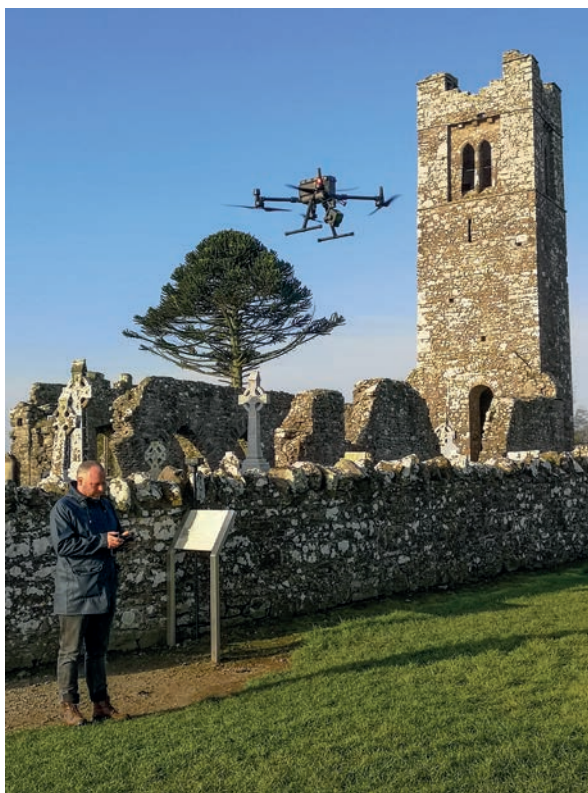
Abb. 25. Die Drohne Matrice 300 mit dem LiDAR-Sensor Zenmuse L1 beim Einsatz auf dem Hill of Slane County Meath (Foto: K. Rassmann, RGK).
