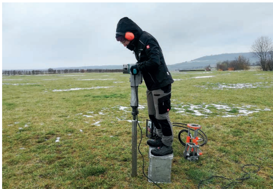
Abb. 5. Ruffenhofen, Deutschland. Isabel A. Hohle beim Bohren mit der Rammkernsonde (Foto: J. Schmauderer, RGK).
