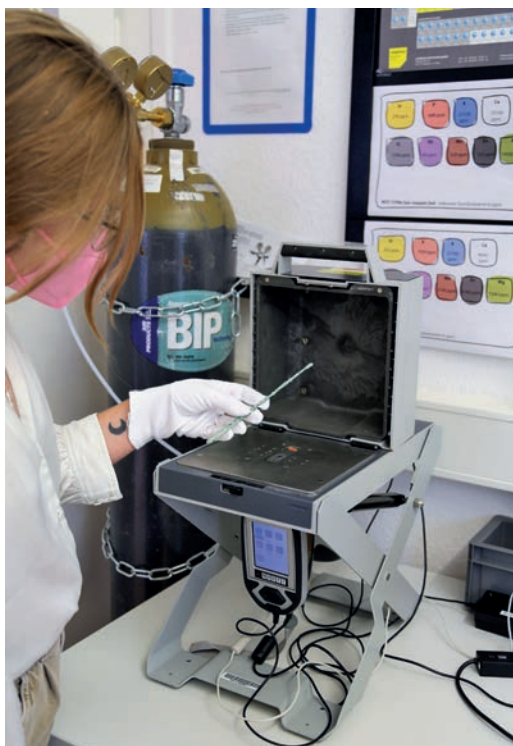
Abb. 35. Provenienzforschung durch Materialanalyse: eines der römischen Arztbestecke wird auf die Messfläche in der Probenkammer gelegt (Foto: I. A. Hohle, RGK).
