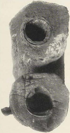
1. Holzrohre mit Einschnittspuren der Deuchelringe. )
