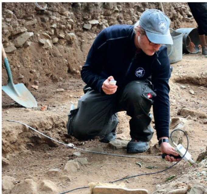
Abb. 5. J. Kalmbach, RGK, bei Suszeptibilitätsmessungen mit dem Sensor MS2K am neu entdeckten Ganggrab unter dem Schloss in Dowth (Foto: K. Rassmann, RGK).
