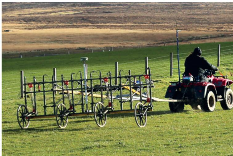
Abb. 51. Fahrzeuggestütztes 14-Kanal Messsystem (SENSYS MAGNETO®-MX ARCH) nahe der neolithischen Siedlung Rinyo auf der Orkneyinsel Rousay im Norden Schottlands (Foto: K. Rassmann, RGK).
