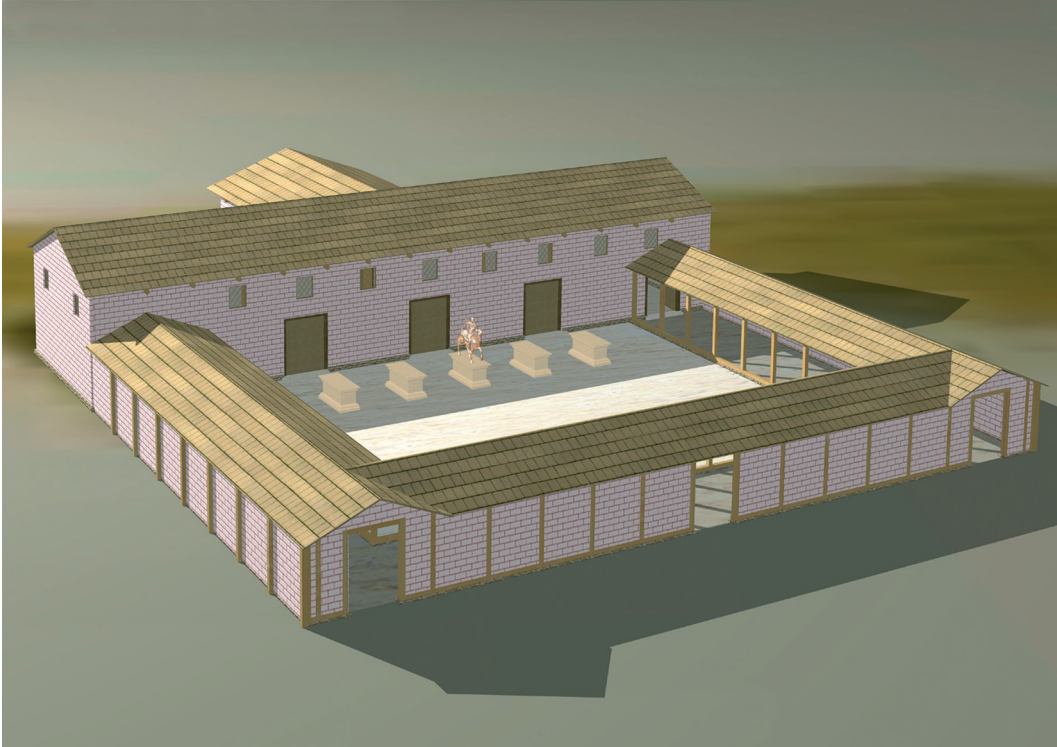
Abb.4. Waldgirmes. Rekonstruktion des in Fachwerkbauweise auf dem Steinfundament errichteten Forums.
