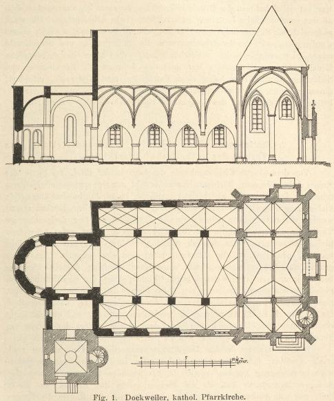
Grundriss und Längenschnitt nach der Erweiterung.
