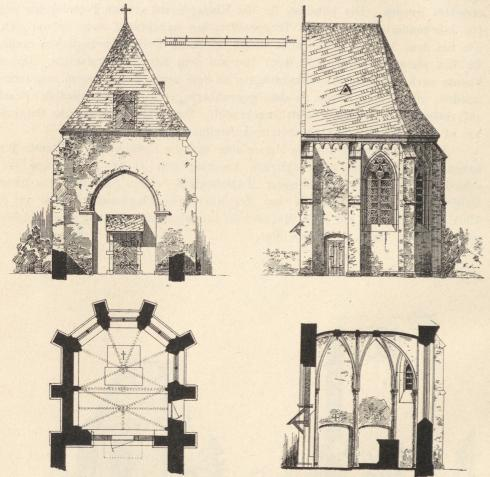
Fig. 13. Welling. Grundriss, Schnitt und Aufrisse des Chores der alten Kirche nach der Herstellung.
