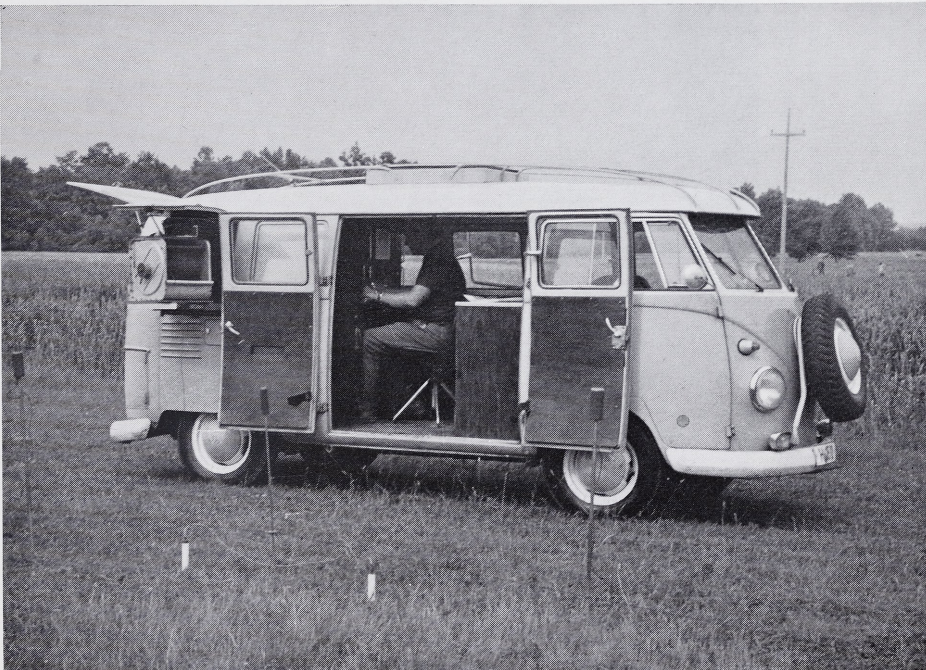
Geländewagen (2) und Gerät (1) für geoelektrische Widerstandsmessungen.
