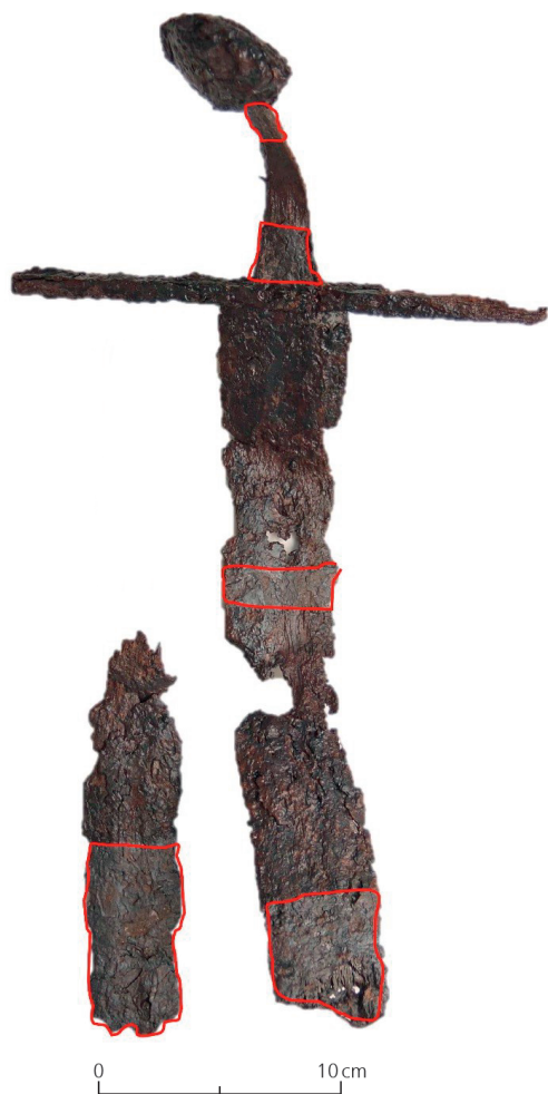
Abbildung 10 Ein stark korrodiertes hochmittelalterliches Schwertfragment aus Kerpen-Buir (Prospektionsfund, HA 2017/0050, Inv. 2018.227,1-1) wurde versuchsweise mit Stärkefettsäureester (Pulverlack) teilbeschichtet.
