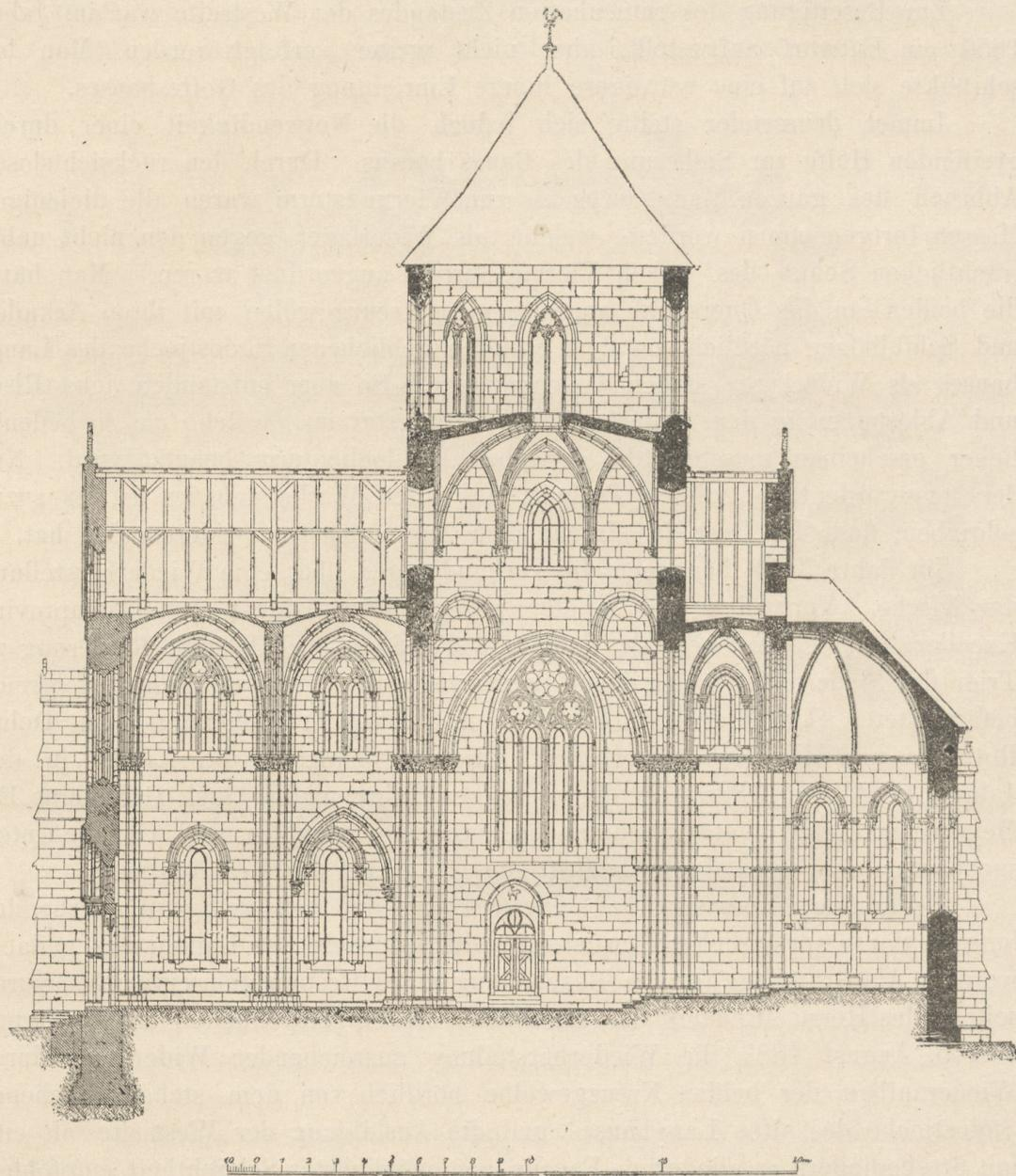
Fig. 17. Offenbach. Längsschnitt durch die Abteikirche.
