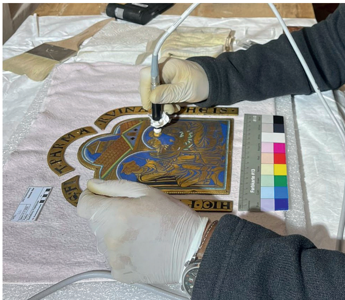
Abbildung 4 Die feuervergoldeten und emaillierten Kupferplatten von Klosterneuburg bildeten ursprünglich eine Verkleidung und wurden um 1330 unter Ergänzung einiger Platten zu einem Triptychon umgebaut. Bei Wirbelstrommessungen, einem zerstörungsfreien Materialprüfverfahren wird die Leitfähigkeit von Metallen in der Tiefe gemessen, welche für jedes Metall beziehungsweise jede Metalllegierung spezifisch ist. Dadurch können Fragen nach der Einheitlichkeit und Zusammengehörigkeit der einzelnen Stücke beantwortet werden.
