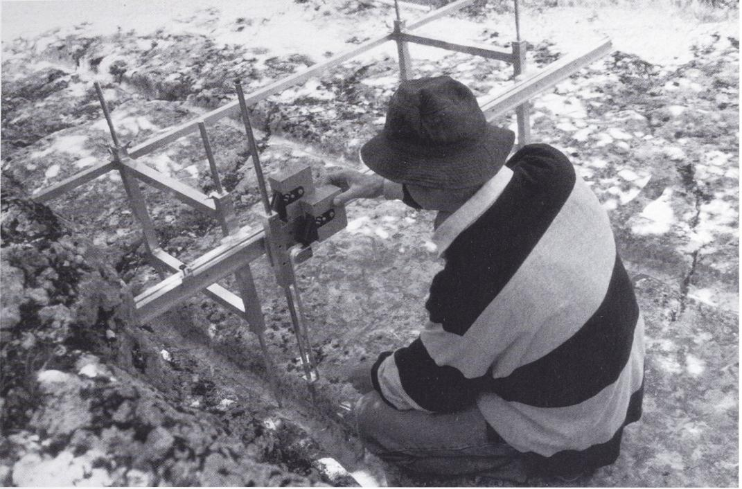
8 Das Messgerät zur Aufnahme von Geleiseprofilen.
