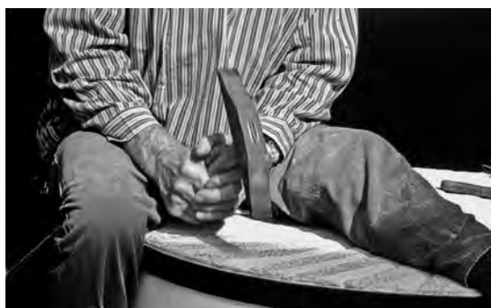
21 Schärfen eines Mühlsteins mit einer Bille.
