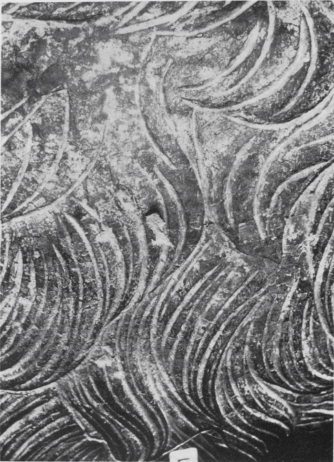
17 Quadratisches Loch eines Abstandhalters auf dem Scheitel, das nicht plattiert wurde.
