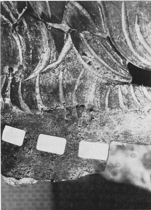
21 Das Lötmaterial bedeckt Teile des vor der Lötung kalt bearbeiteten Nackenhaares.
