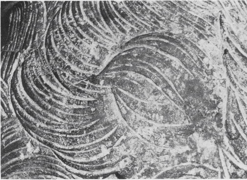
12 Die Naht der beiden Hälften des Wachsmodells.
