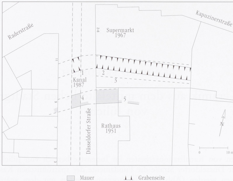
1 Mittelalterlicher Stadtgraben von Jülich. 1 = Grabenverlauf im Kanalschnitt 1987 (FNr.160/161); 2 = Grabenverlauf nach Baustellenbeobachtung 1967 (FNr.320/D); 3 = Grabenverlauf nach PIEPERS (Anm.2) Abb.34; 4 = Kastellmauerverlauf in Kanalschnitt 1987; 5 Mauerrest nach HABEREY (Anm.2) Abb.44.
