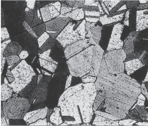
24 Reiterhelmmaske aus Dormagen, Rheinisches Landesmuseum Bonn. Gefügebild mit rekristallisiertem Gefüge.
