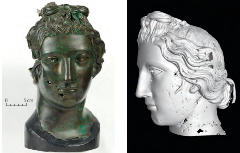
Abb. 57 a–b Bronze- kopf einer weiblichen Gottheit aus Mainz, sogenannte Rosmerta (GBL 397–399). Mainz, Landes- museum. (a) An- sicht. – (b) Mit Hilfe der Computertomo- graphie lassen sich zahlreiche Gussfehler im Bereich der linken Kopfseite darstellen.
