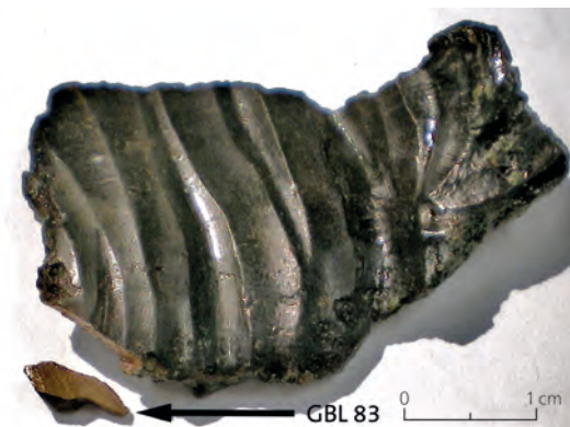
Abb. 29 a–b Haarfragment aus Aalen (GBL 83) mit schwarzer Oberfläche. Rechts im Bild Anschliffprobe mit hellen Bereichen der Zinnseigerung.
