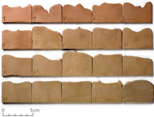
Abb. 10 Zinnbronzen und deren variierende Farbtöne. Experimentelle Güsse ohne moderne Zuschlagstoffe aus reinem Kupfer und Zinn mit steigendem Zinnanteil von einem bis zwanzig Prozent.
