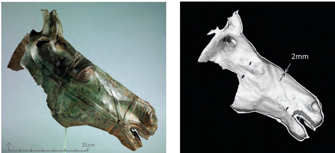
Abb. 3 a–b Originaler und in der Computertomographie geöffneter Pferdekopf aus Augsburg (GBL 29–30). Schnittbilder ermöglichen Messungen der Materialstärke auch in unzugänglichen Bereichen. Augsburg, Römisches Museum.
