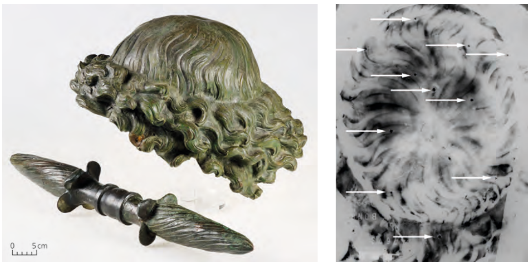
Abb. 77 a–b Haarkalotte (GBL 504) und Blitzbündel (GBL 505) einer Jupiterstatue aus Womrath. Im Röntgenbild sind die Kernhalteröffnungen (2 x 2 mm) mit Pfeilen markiert. Diese waren ursprünglich mit kleinen Bronzeperlen verschlossen. Landesmuseum Bonn.
