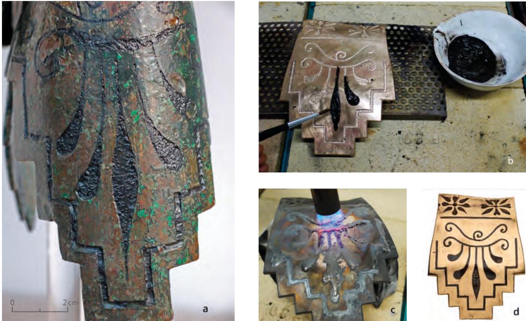
Abb. 38 a–d Nielloeinlagen an einer Satteldecke aus dem Rheinland im Original und im Experiment. Landesmuseum Bonn. – (a) Detail des Originals. – (b) In zuvor eingearbeitete Vertiefungen wird mit Wasser gemischtes Niellopulver (verschmolzene Mischung aus Silber, Kupfer, Blei und Schwefel) eingebracht. – (c) Erhitzen und Schmelzen des Niello bei etwa 500 °C. – (d) Abgeschliffene und polierte Oberfläche nach dem Niellieren.
