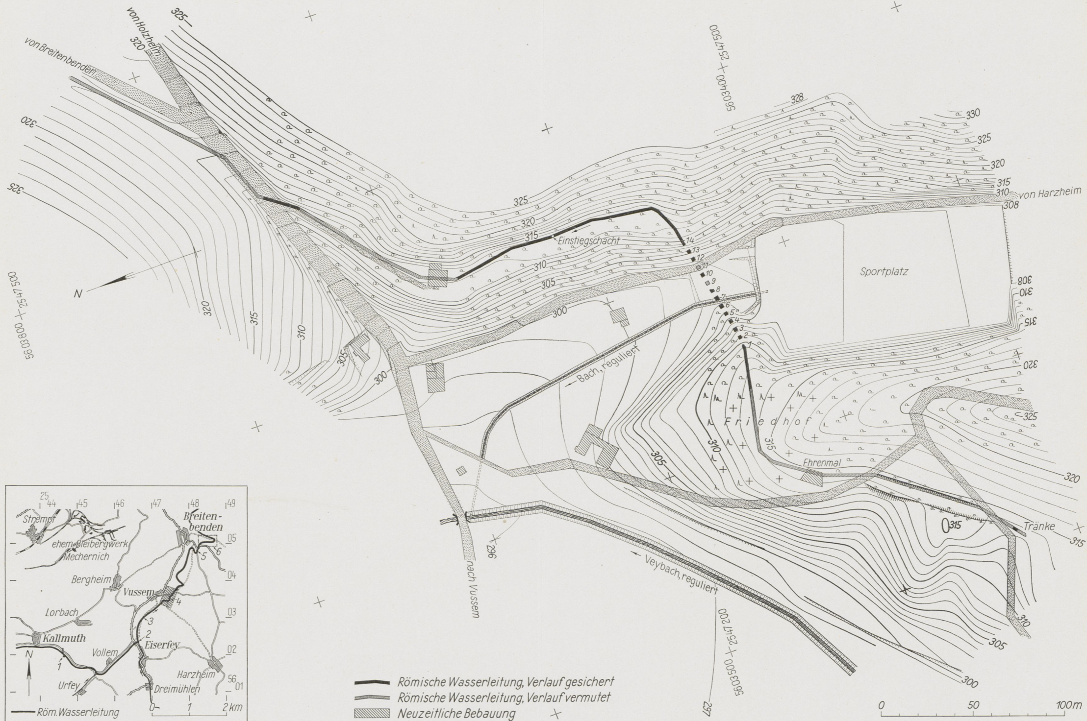
25 Vussem, Kreis Schleiden. Verlauf der römischen Wasserleitung nach Köln mit den Resten des Aquäduktes (Punkt 4 der Übersichtskarte 1 : 100 000). Maßstab 1 : 2 000.
