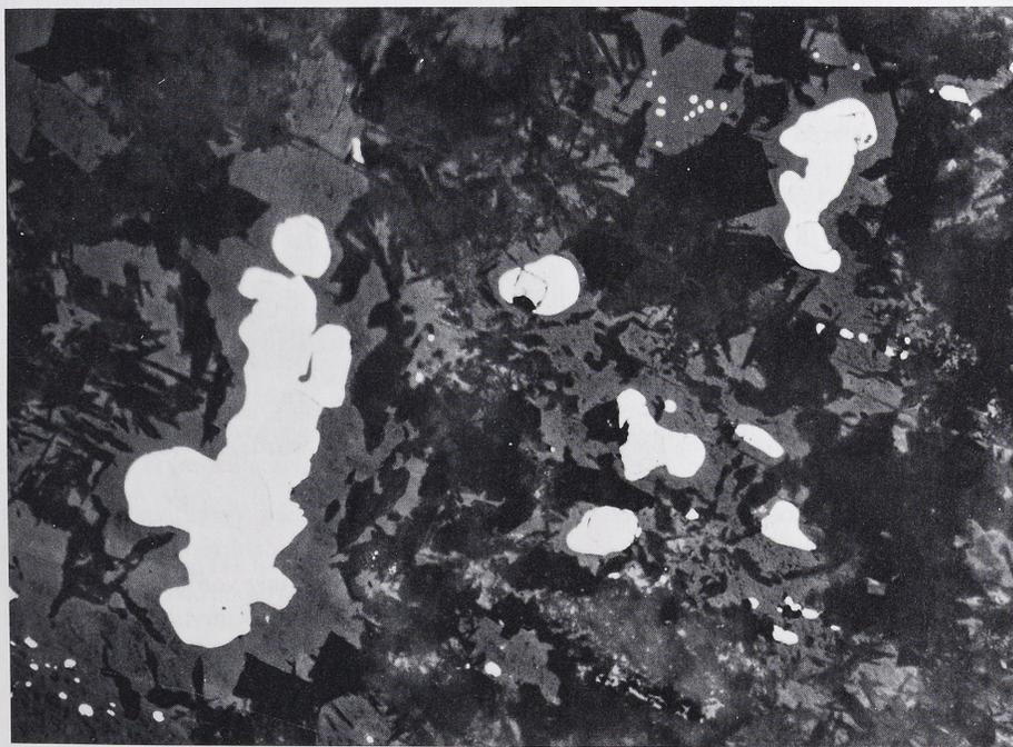
2 Wie Abb. 1 (500fach vergrößert); das Schlibbild zeigt den äußeren Rand der Probe, in dem nadelige Bleikarbonatkristalle dominieren.
