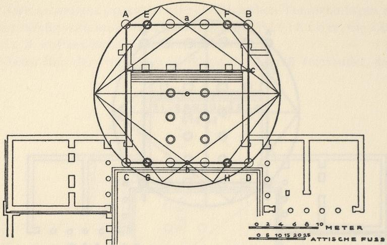
Abb. 5. Geometrische Bestimmung der Säulenmittelpunkte E, F, G, H.
