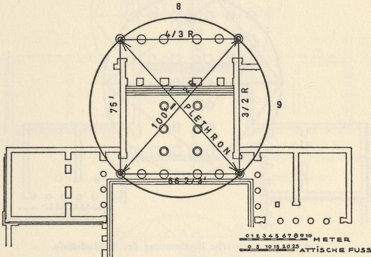
Abb. 1. Grundmaß: der Kreis mit 100 Fuß Durchmesser.
