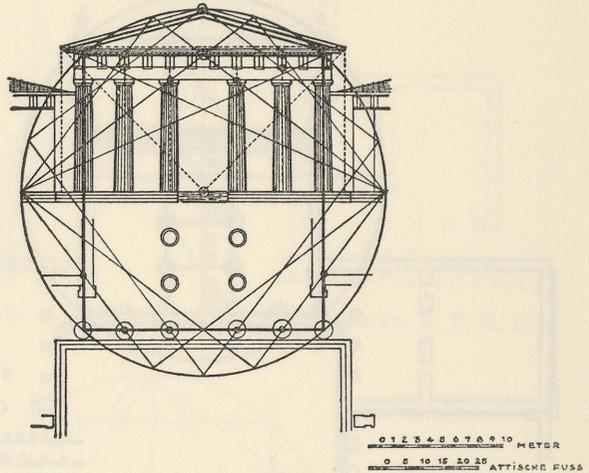
Abb. 8. Geometrische Bestimmung der Höhen von Säulen, Architrav, Fries und Giebelspitze.
