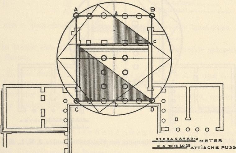
Abb. 4. Geometrische Bestimmung der Trennwand.
