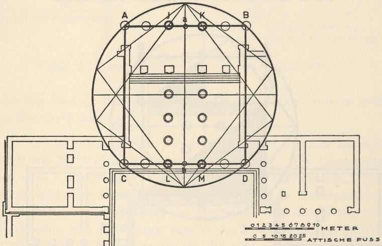
Abb. 6. Geometrische Bestimmung der Säulenmittelpunkte J, K, L, M.
