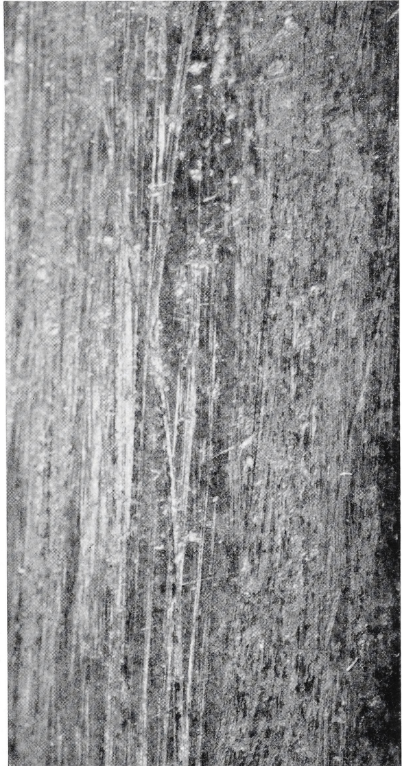
3 Alte Schleifriden auf der Klinge. Vergrößerung 8 : 1.
