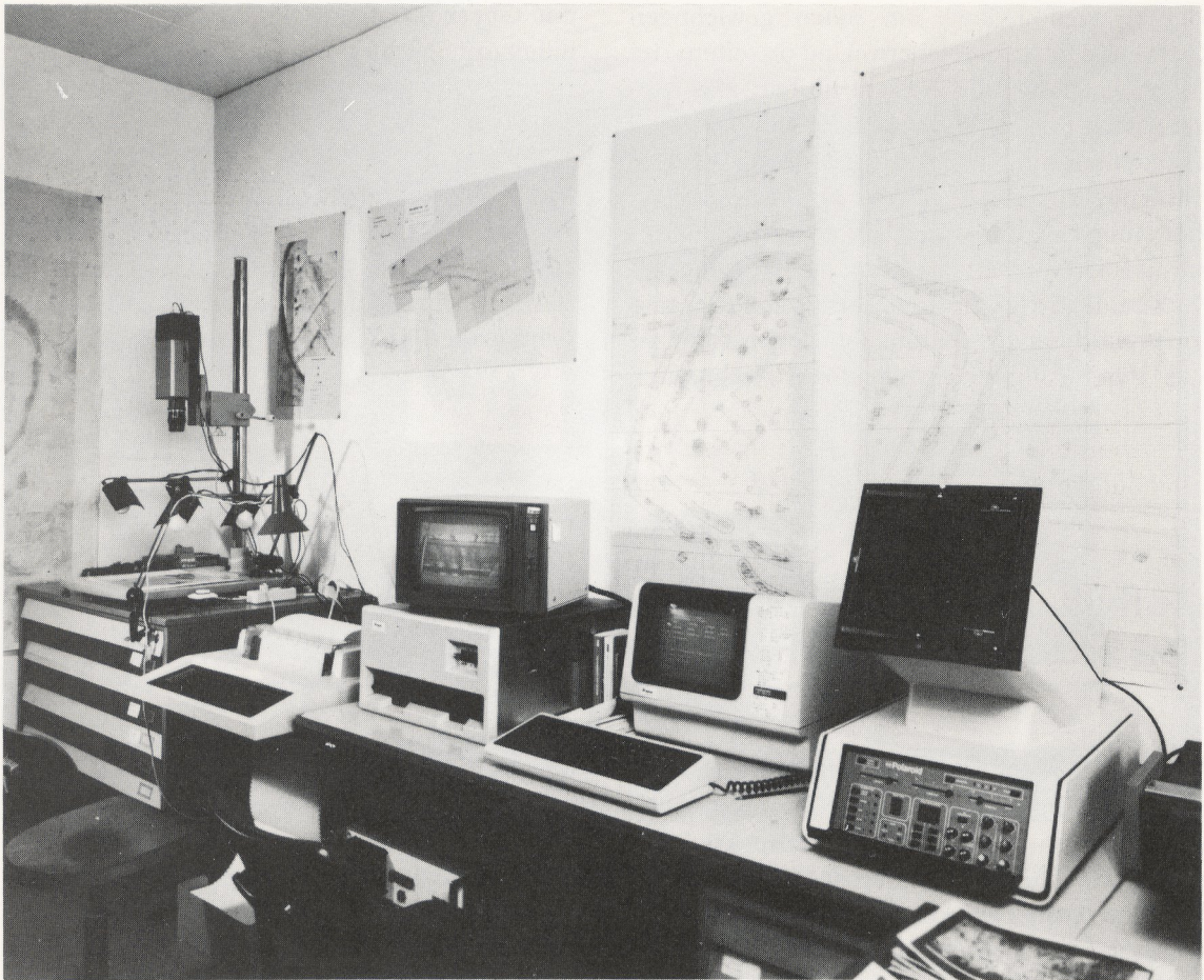
149 Aufbau der Anlage zur digitalen Verarbeitung von archäologischem Luftbild und Magnetometerprospektion am Bayer. Landesamt für Denkmalpflege. Die Geräte im einzelnen von links nach rechts: Videokamera zur Bild- und Karteneingabe, Drucker, Computer mit dem Bildverarbeitungssystem, Monitor, Kassettenlesegerät (unten), Sichtschirm zur Programmsteuerung und Videoprinter zur Bildausgabe.
