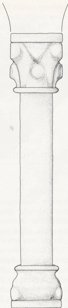
125 Altrandsberg. Spätromantisches Kapitell und Säulenbasis sowie Rekonstruktion der Fenstersäule im Maßstab 1:10.
